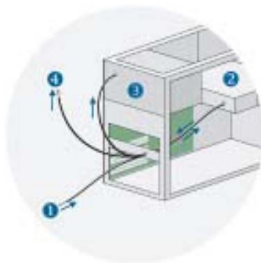
Conectado a la red eléctrica (1), el ALPHA 500 inT (2) asegura una alimentación ininterrumpida de su PC (3) y de su pantalla (4).
